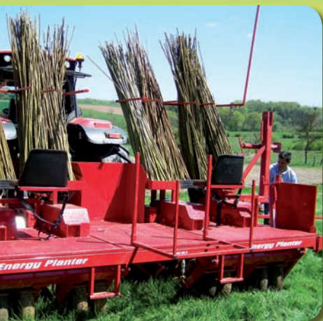
Photo : C.A. 88 Planteuse 4 rangs d'origine danoise
