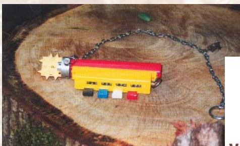
Relascope à chaînette muni d'un compteur
