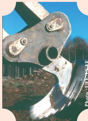
Photo de gauche : lame de dessouchage "dent Becker" Photo de droite : Pelle munie d'un râteau scarificateur
