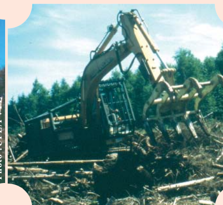
Photo de gauche : lame de dessouchage "dent Becker" Photo de droite : Pelle munie d'un râteau scarificateur
